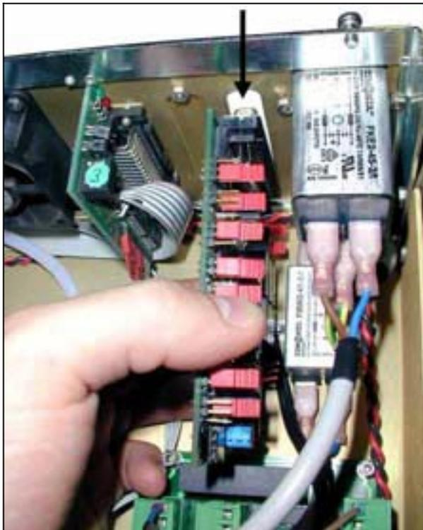
(2) Зафиксируйте плату в гнезде при помощи винтов.
